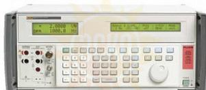
Многофункциональный калибратор **Fluke 5502E 240** – многорежимный цифровой высокоточный прибор лабораторного класса, оснащенный функциями воспроизведения базовых электрических параметров и эмуляции сигналов датчиков, с возможностью автоматического расчета погрешности относительно эталонного параметра.
