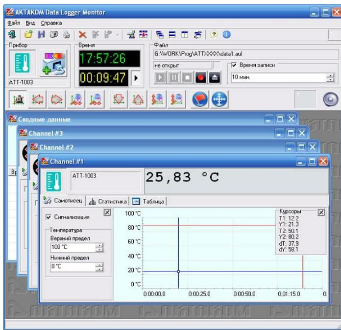
Приложение позволяет одновременно подключать несколько приборов и, соответственно, снимать измерения с нескольких каналов. Типы данных, измеряемых по разным каналам, могут совпадать или быть различны. Общее количество подключений теоретически тоже не ограничено, но на практике использовать бесконечный список каналов не позволит ограниченность ресурсов компьютера.
