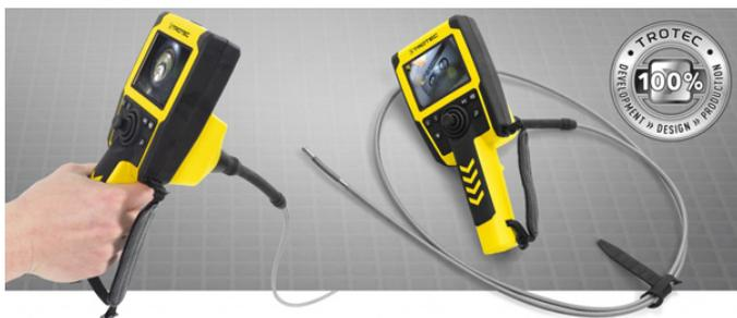
Надежный **Trotec VSC206** оснащен зондом (IP67) длиной 2 м (ø 6 мм), который изготовлен из нержавеющей стали и полиуретана на гибкой стальной спирали. Используя джойстик, головку камеры **Trotec VSC206** с титановым покрытием можно легко повернуть во все стороны. Промышленный видеоскоп **Trotec VSC206** поставляется в прочном футляре для переноски. Адаптер питания, аккумуляторы, зарядное устройство, SD-карта и ткань для очистки в комплекте.
