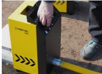
Производительность турбины вентилятора и гидравлического насоса можно плавно регулировать независимо друг от друга.
