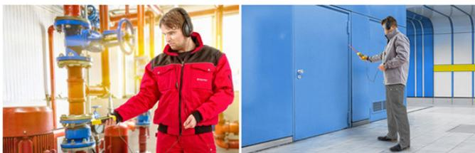
Признаки износа насосов и других обрабатывающих машин можно обнаружить на ранней стадии с помощью структурного зонда. В сочетании с ультразвуковым передатчиком **Trotec SL800T** испытания на герметичность выполняются быстро и с низкими затратами.
