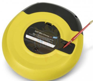
Система локации LTC3020 с тонким толкающим кабелем диаметром 3 мм и головкой датчика диаметром 7–10 мм идеально подходит для обнаружения проходов, перекрытий труб и возможных засоров в домашних условиях. Система локации LTC легко преодолевает даже маршруты со сложными сгибами в действующих трубопроводных системах на довольно большие расстояния.
