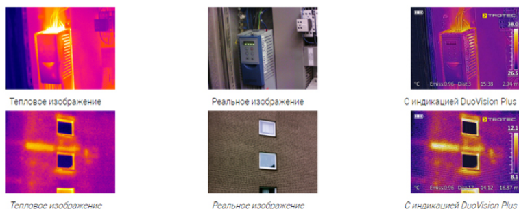
Рис.1. Преимущества использования дисплея XC600 DuoVision Plus (опция)
