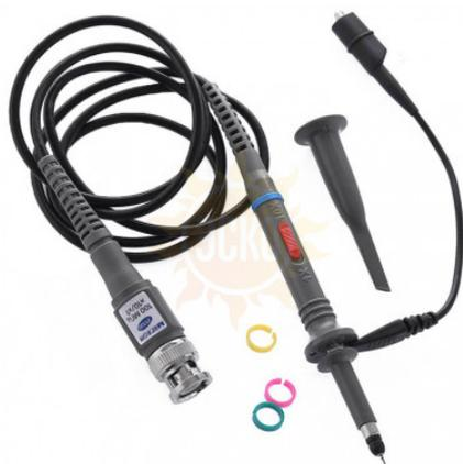
Щуп для осциллографа **МЕГЕОН 25100** представляет собой компактный и удобный щуп для осциллоскопа. Данный щуп имеет переключатель деления 1x/10x. Так же есть регулировка компенсации щупа. В комплекте так же идет маркерные цветные кольца для того, чтобы было удобнее определять к какому каналу по цвету маркера подключена ручка щупа. Для замеров в не самых удобных местах есть специальные колпачки, так же есть и колпачок крюк, для удобного подсоединения к проводам измеряемого сигнала.
