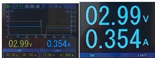
Экран прибора позволяет одновременно отображать установленные и измеренные значения напряжения, тока, а также позволяет выводить на экран потребляемую мощность подключенной нагрузки. Указанная функция может быть весьма полезна при разработке электронных устройств, а также при их диагностике и ремонте.
