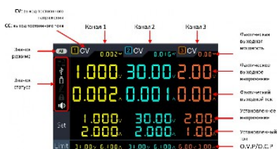
Цветной экран позволяет отображать данные по каждому каналу своим цветом: канал 1 – желтым, канал 2 – голубым, канал 3 – оранжевым.
