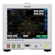
Высокоскоростной измеритель иммитанса (RLC) предназначен для измерений радиотехнических параметров: сопротивления, индуктивности и емкости, для анализа АЧХ радиокомпонентов и 5-ти типовых схем с элементами RLC в диапазоне частот от 1 МГц до 300 МГц.
