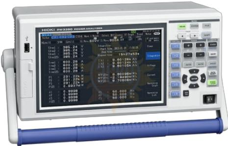
Модификация PW3390 является новейшей разработкой компании и предназначен для высокоточного измерения мощности. Прибор может работать с однофазными сетями и 3-х фазными 3-х и 4-х проводными сетями. Прибор обеспечивает анализ гармонических составляющих и измерение тока, напряжения, частоты, вибраций, скорости вращения, (при использовании соответствующей опции).
