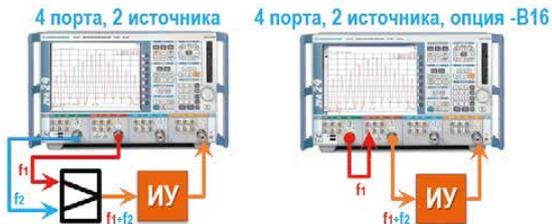
ZVA позволяет получить 2 разных типа результатов: один при измерениях с разверткой по частоте или по мощности, другой при анализе спектра интермодуляционных составляющих.
