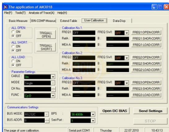
Программное обеспечение AM-3018-SW существенно расширяет возможности применения измерителя RLC AM-3018, позволяя не только производить уделённую настройку прибора и наблюдать за результатами измерений, но и осуществлять графический анализ частотных характеристик измеренных параметров.
