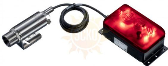
Дополнительное оборудование для инфракрасной камеры Xi 80/410. Светодиодный индикатор подключается напрямую к ИК-камере и служит для визуальной и звуковой сигнализации превышения/уменьшения допустимого уровня температуры. Индикатор аварийной сигнализации работает в автономном режиме вместе с камерой, и может стать отличным предупредительным сигналом в системах безопасности.
