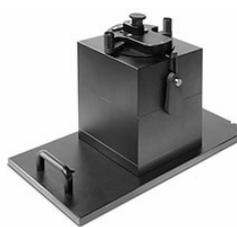
Приставка предназначена для исследования абсолютного квантового выхода новейших материалов (как твердых, так и жидких).
