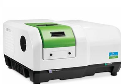
Спектрометр предназначен для исследования свойств материалов, количественного анализа малых концентраций в условиях заводской лаборатории, экологического и агрохимического контроля, исследования светодиодов, солнечных батарей и электролюминесцентных материалов. Высокая скорость сканирования – до 60000 нм/мин – для анализа сверхбыстрых процессов.
