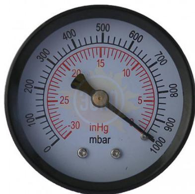
Вакуумметр **МЕГЕОН 98030L** предназначен для замены неисправного или повреждённого прибора участвующего в технологическом процессе, а также на технологическом оборудовании и комплексах. Корпус изготовлен из стали и имеет заднее крепление. Максимальное измеряемое разрежение составляет -1 Бар. Присоединительный размер резьбы G1/8".
