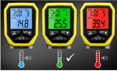
**Зеленый, если значение в допустимом диапазоне.** Вы указали опорное значение 25 °C и установили пороговое значение 1 °C. Если измеренная температура поверхности составляет от 24 °C до 26 °C – то есть находится в пределах допустимого диапазона, дисплей горит зеленым цветом.
