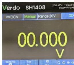
Осциллографы VERDO SH1400 имеют встроенный 1-канальный мультиметр, метрологические параметры которого внесены в описание типа прибора. Диапазон отображаемых измерений – 4 1/2 разряда (20 000 отсчетов). Базовая погрешность прибора 0,3%, измеряемые величины: напряжение и ток постоянного и переменного тока, сопротивление, емкость, также встроенные функции тестирования диодов и прозвонки цепи.
