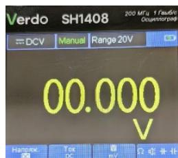
Осциллографы VERDO SH1400 имеют встроенный 1-канальный мультиметр, метрологические параметры которого внесены в описание типа прибора. Диапазон отображаемых измерений – 4 ½ разряда (20 000 отсчетов). Базовая погрешность прибора 0,3%, измеряемые величины: напряжение и ток постоянного и переменного тока, сопротивление, емкость, также встроенные функции тестирования диодов и проверки цепи.
