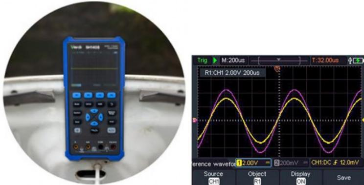
Благодаря встроенному противоударному хольстеру прибор не боится случайных падений и ударов, а малые размеры и опорная скоба позволяет его удобно размещать на элементах конструкции обслуживаемых объектов. Пластиковое покрытие внешней поверхности входных осциллографических разъемов делает работу с прибором более безопасной, предотвращая случайное соприкосновение оператора с высоким напряжением.
