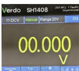
Осциллографы VERDO SH1400 имеют встроенный 1-канальный мультиметр, метрологические параметры которого внесены в описание типа прибора. Диапазон отображаемых измерений – 4 ½ разряда (20 000 отсчетов). Базовая погрешность прибора 0,3%, измеряемые величины: напряжение и ток постоянного и переменного тока, сопротивление, емкость, также встроенные функции тестирования диодов и прозвонки цепи.
