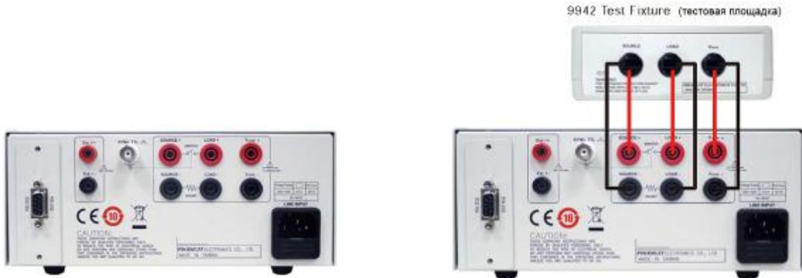
На рис. справа – подключение AC нагрузки с помощью опциональной тестовой площадки 9942
