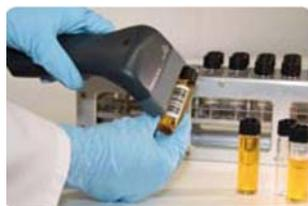
**Сканер штрих-кода** рекомендуется при средней и высокой производительности в лаборатории. Значительно упрощает идентификацию образца и исключает возможность ошибки.
