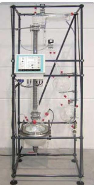
Автоматическое устройство для перегонки растворителей - **Distillation Device SR6**
