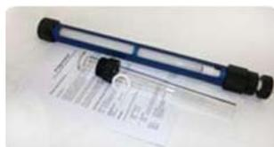
Компания LCTech предлагает **колонок для гель-проникающей хроматографии** в двух вариантах: наполненные частицами bio-beads в различных растворителях и ненаполненные различной длины.
