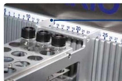
В автоматизированной системе Freestyle GPC может использоваться лабораторная посуда различного объема от 1 мл до 1000 мл в любой комбинации. Номер штатива (№15 на данном рисунке) соответствует такой же позиции в программном обеспечении.
