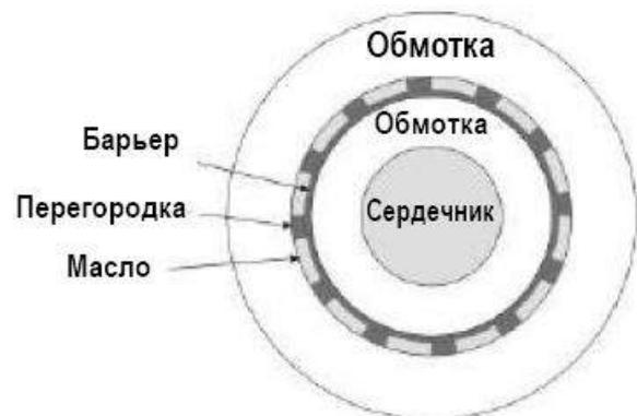
Рис. 3. Типичная структура изоляции
