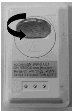
2. Откройте крышку аккумуляторного отсека логгера данных поворотом влево и снимите её.
