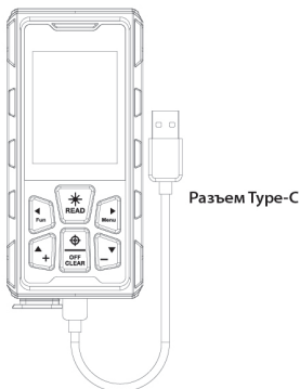
Рис. 5 Зарядка литий-ионной батареи
