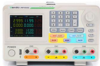
Программируемые источники питания постоянного тока VERDO PP1500 имеют традиционную линейную схемотехнику, благодаря чему выдают выходное напряжение (до 30 или 60 В) и ток (до 3 или 6 А) высокого качества по 3-м независимым регулируемым каналам, 1 и 2-й из них – основные, а 3-й – вспомогательный.
