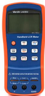
Профессиональные LCR-метры с тестовой частотой до 100 кГц и базовой погрешностью до 0,1%, обеспечивают инженеров мощным портативным инструментом для подбора пассивных компонентов на производстве и в ходе отладки и проектирования электронных систем. Функция автоматической идентификации типа компонента по его импедансу (функция измерения, диапазон, тестовая частота и эквивалентная схема выбираются автоматически), сортировка по допуску делают работу с прибором простой и удобной.
