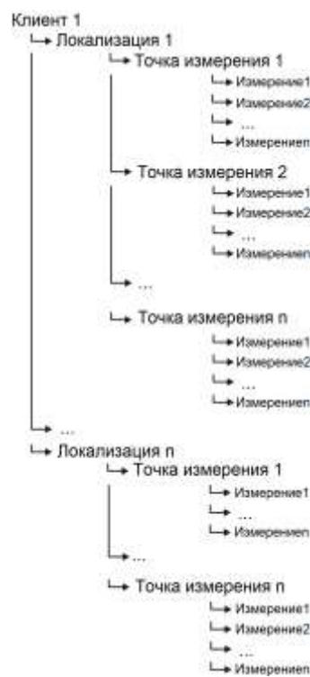
Рис. 7.1. Структура памяти измерителя для отдельного клиента
