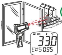
Прибор не может измерить температуру объекта находящегося за прозрачным или полупрозрачным препятствием, например: стекло, пар, дым и т.д. – он будет измерять температуру этого препятствия
