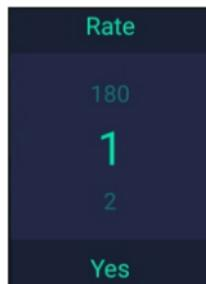
В разделе **Meter Storage Interval** ◀ установите интервал записи в приборе. Выбор подтвердите нажатием кнопки **YES**.
