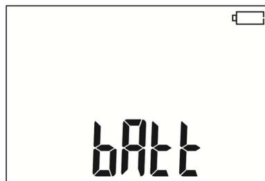
Аккумулятор полностью разряжен, все измерения блокируются. Измеритель автоматически отключится через 5 секунд.
