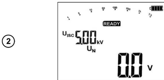
Надпись **READY** сигнализирует о готовности выполнения измерения нарастающим напряжением.
