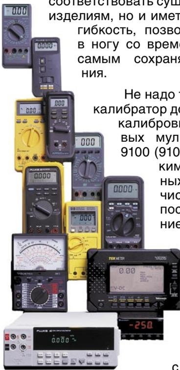
практически любого мультиметра. Ни один из калибраторов в этом классе не способен обеспечить выдачу сигнала напряжением 1050 В при частоте 10 кГц, 350 В при 30 кГц или 20 А при 10 кГц без использования внешнего усилителя мощности или преобразователя. Даже в режиме генерации сопротивления модель 9100 может работать с вплоть до 350 мА, используемыми старыми аналоговыми мультиметрами.
