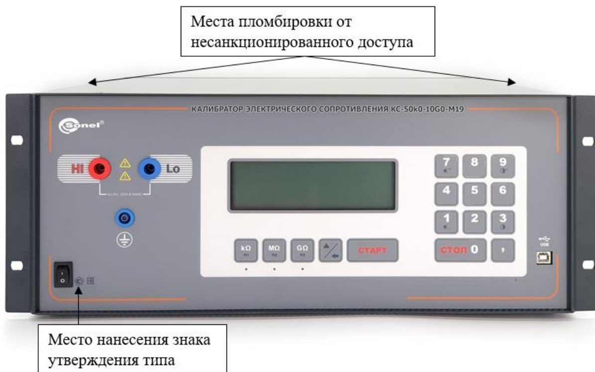
Рисунок 1 – Общий вид калибратора электрического сопротивления КС-50k0-10G0-M19
