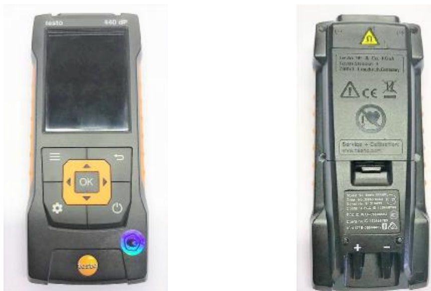
а) в качестве отдельной наклейки или б) на информационной этикетке Рисунок 2 – Место нанесения знака утверждения типа
