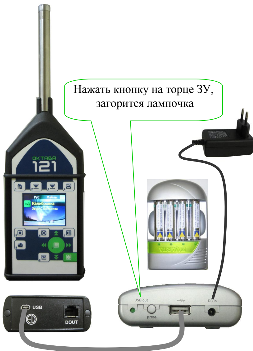
Схема 3. Подключение прибора к внешнему источнику питания
