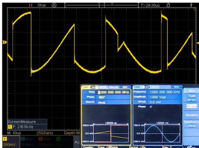
В генераторах GW1400 также есть режим модуляции SUM (суммирования), который позволяет сложить сигнал генератора с другим выбранным сигналом или внешним сигналом, который подается вход внешней модуляции прибора. Таким образом, например, можно симитировать полезный сигнал с наложенным шумом.
