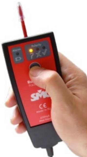
Тестер полярности Raptor PT представляет собой простой ручной инструмент, который поможет быстро проверить полярность в различных точках вторичной цепи в трехфазных установках, анализируя специальный сигнал, который подает Raptor в первичную обмотку любых типов трансформаторов: ТТ, ТН, силовых трансформаторов. Это особенно удобно, когда требуется проверить полярность на удаленных участках в труднодоступных местах.
