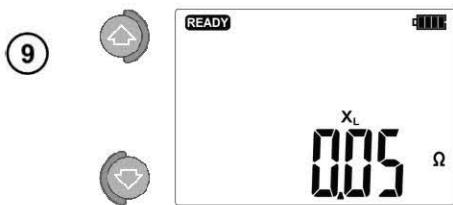
$X_L$  -- реактивное сопротивление петли короткого замыкания
