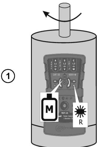
Приложите задней панелью указатель TKF-13 к работающему электродвигателю, вдоль оси вращения вала.
