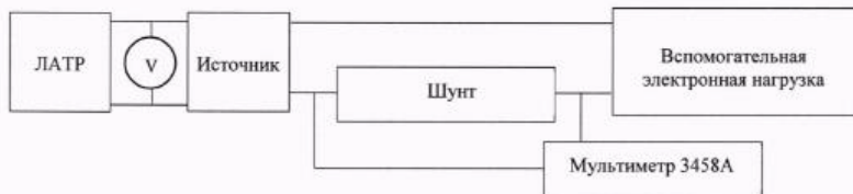
Рисунок 5 – Структурная схема определения нестабильности выходного сигнала силы постоянного тока, вызванной изменением напряжения питания
