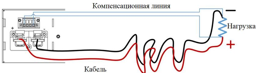
Рисунок 3 - Принципиальная схема подключения компенсации напряжения
