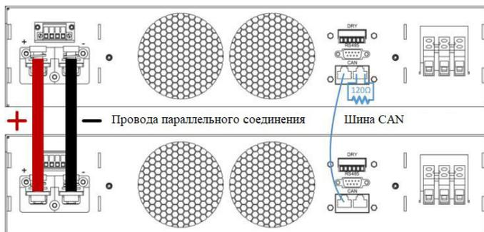
Рисунок 4 - Схема параллельного подключения двух приборов
