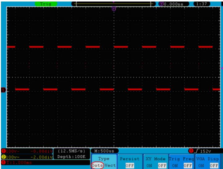
Рисунок 5.30. Отображение осциллограммы в растровой форме
