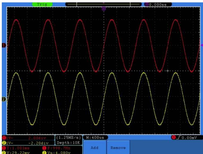
Рисунок 5.72. Вид осциллограммы при курсорных измерениях напряжения
