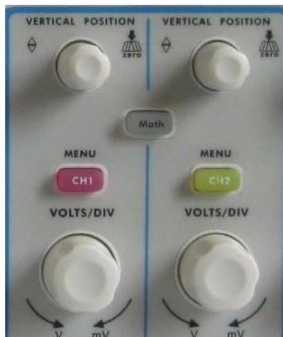
Рисунок 4.6. Поле управления вертикальной шкалой
