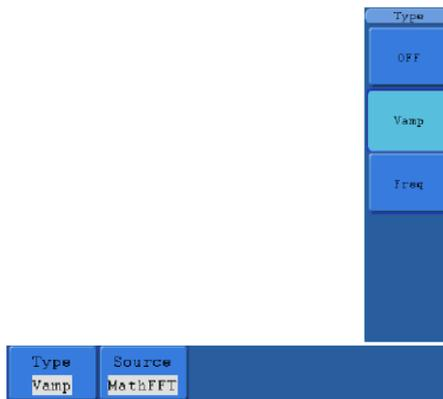
Рисунок 5.74. Меню функции курсорных измерений в режиме FFT
