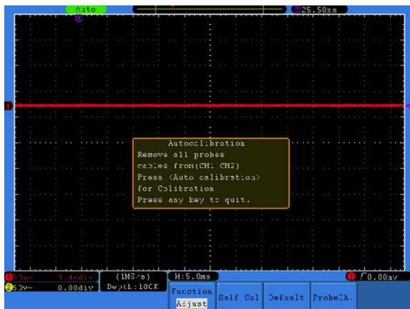
Рисунок 5.46. Автокалибровка осциллографа
