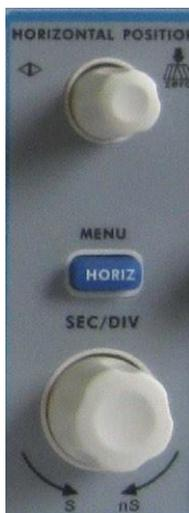
Рисунок 4.7. Поле управления горизонтальной шкалой
