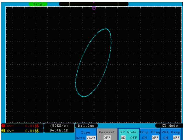
Рисунок 5.32. Отображение осциллограммы в формате XY.
