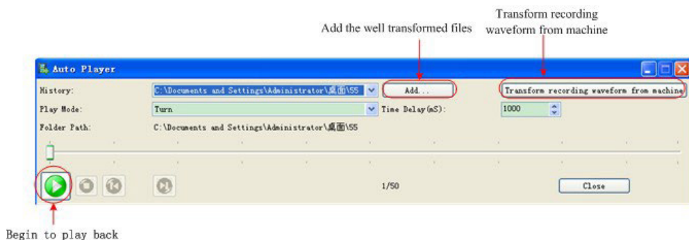
Рисунок 4-19: Воспроизведение осциллограммы на ПК
