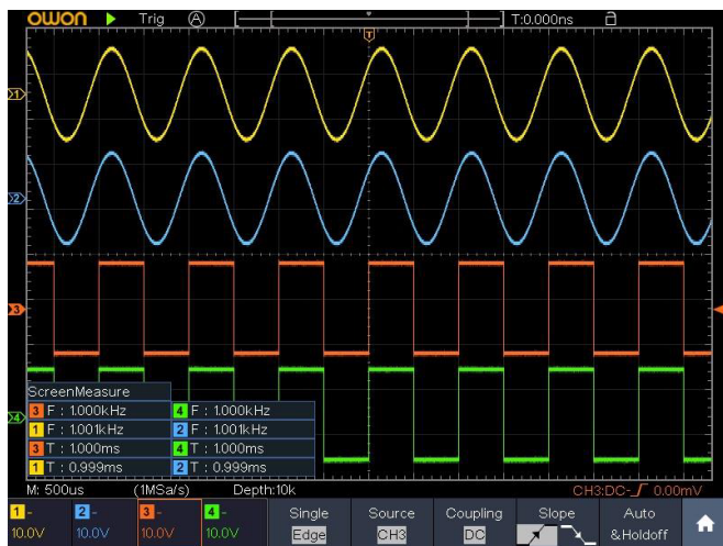
Рисунок 49 - Измерения периода и частоты для данного сигнала
