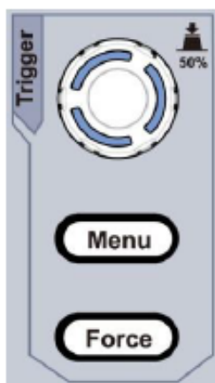
Рисунок 11 - Зона управления триггером
