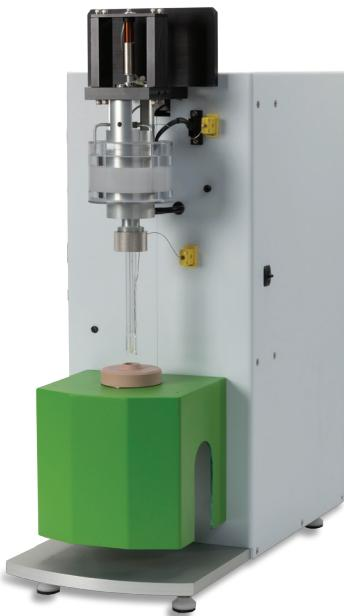
Уникальная плавающая подвеска, работающая по закону Архимеда, полностью компенсирует вес идентора и его привода.
